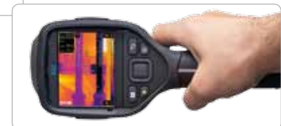
自動方向検知でカメラの向きに合わせて測定値を添付
