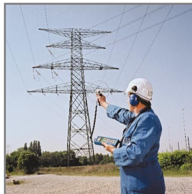
◆ 電気機器のコロナ放電の検知 (トラッキング、アーシング)
