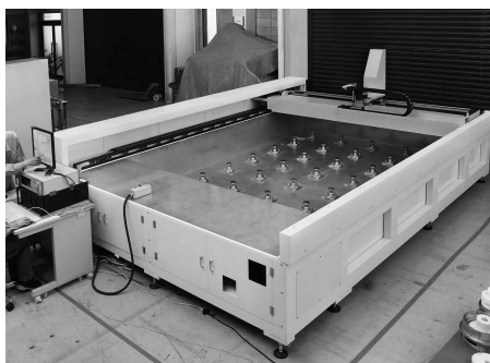
スキャナーとの組み合わせにより 大型構造物の高速探傷が可能
