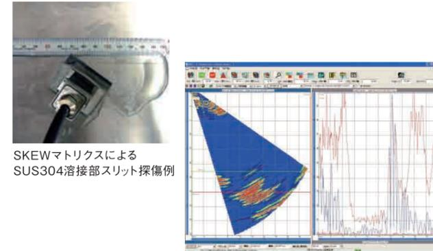
SKEWマトリクスによる SUS304溶接部スリット探傷例
