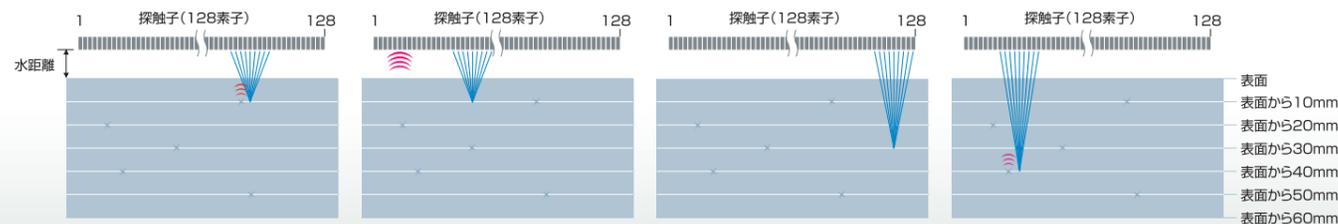
マトリクスアレイスキャンニングは、128ch 同時励振を可能とした Flash Focus システムの特徴的な探傷方式です。円形又は行 × 列に配列された振動子を駆動する事により、従来方式では不可能であった、前後左右を問わない自在な超音波ビームを発生させます。
