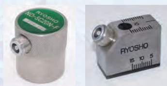
練習専用垂直探触子
