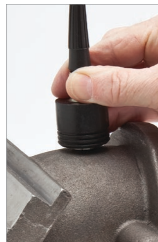
ハイペネトレーション（高浸透）のソフトウェアオプションにより、鋳物などの超音波減衰材料の肉厚測定が可能
