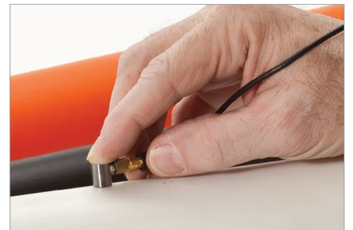
プラスチック、金属、ゴム、ガラス、セラミック、および複合材の肉厚を測定
