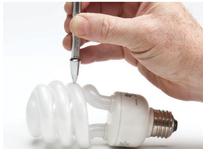
高分解能ソフトウェアオプションにより、最大分解能0.001 mm (0.0001インチ) の精密な肉厚測定が可能
