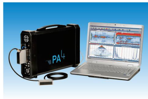
●ポータブルフェイズドアレイ超音波探傷装置 PA4
